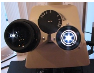
Изображение апертурной диафрагмы
